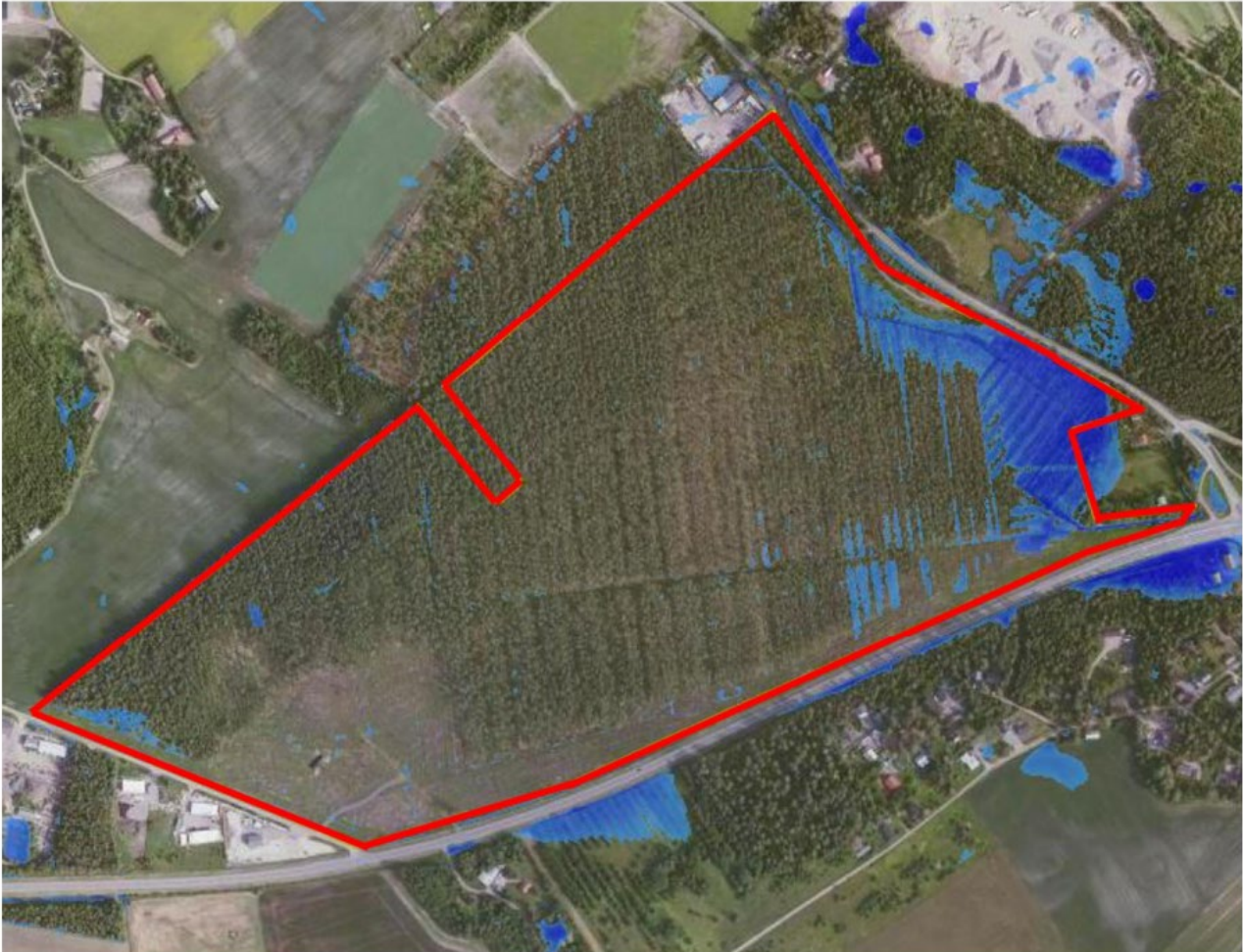
Kuva 11. Alustava arvio mahdollisista tulvariskialueista (SCALGOLIVE-ohjelmisto).
